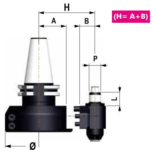
Gruppo antirotante tipo 1 - 2 (Anello + Gruppo perno) Anti-rotation group type 1-2 (Ring + Pin group)
